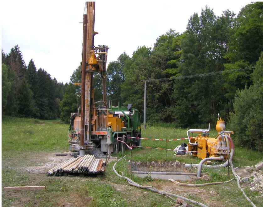
Obr.2.2. Mobilní vrtná souprava Wirth B1A
